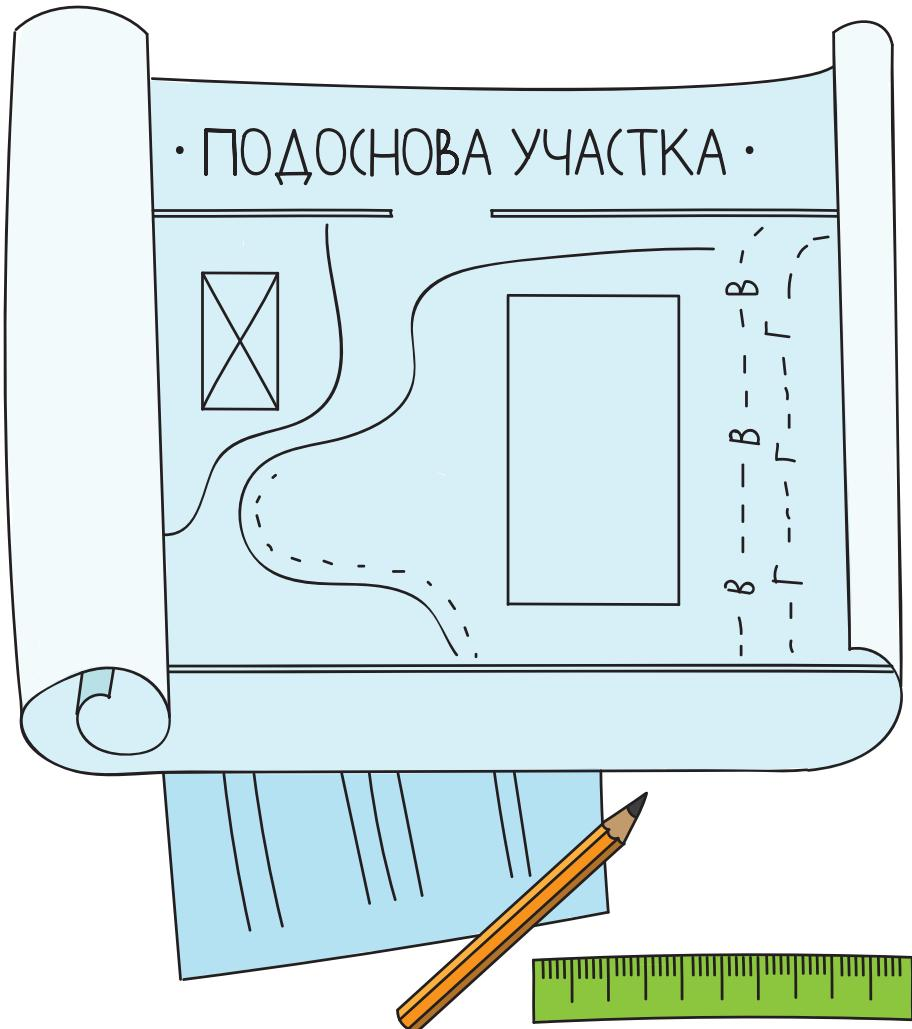
Подоснова – схема участка в масштабе 1:500 с геодезическими и геологическими данными о площадке, с нанесёнными строениями и инженерными коммуникациями.
